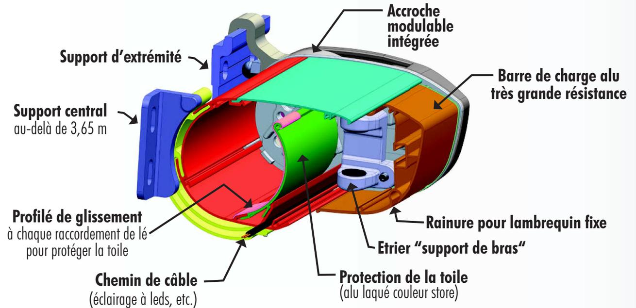
Coffre du store et barre de charge, **modèles déposés**
