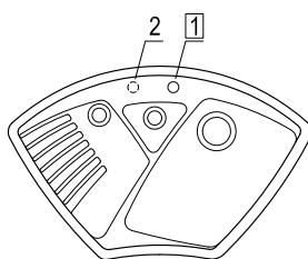
Les trous signalés par la lettre □ sont standard et percés en usine.
