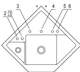
Les trous signalés par la lettre □ sont standard et percés en usine.
