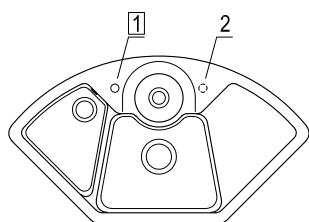
Les trous signalés par la lettre □ sont standard et percés en usine.
