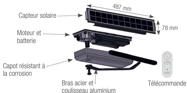
La motorisation est composée d'un module principal avec sa télécommande et d'un capteur solaire.
